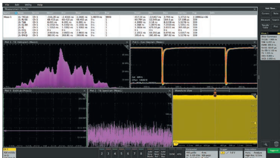
Рис. 4. Джиттер тактовой частоты 1,25 МГц не связан с некоррелированными компонентами DJ
