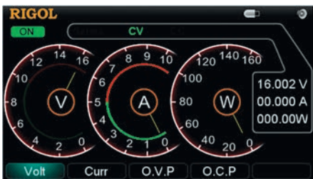
Рис. 11. Вид дисплея источника питания Rigol DP1308A в виде циферблата
