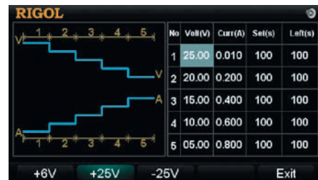
Рис. 7. Вид дисплея источника питания Rigol DP1308A в режиме работы по списку
