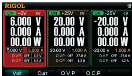
Рис. 3. Вид дисплея источника питания Rigol DP1308A в основном режиме
