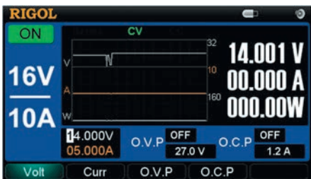
Рис. 10. Вид дисплея источника питания Rigol DP116A в графическом режиме
