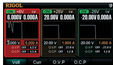
Рис. 5. Вид дисплея источника питания Rigol DP1308A в графическом режиме
