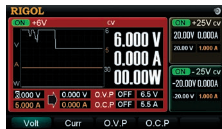
Рис. 6. Вид дисплея источника питания Rigol DP1308A с выделением одного канала в графическом режиме
