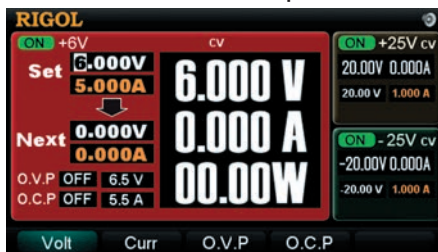
Рис. 4. Вид дисплея источника питания Rigol DP1308A с выделением одного канала
