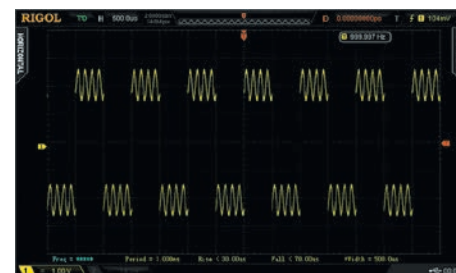
Рис. 20. Результат наложения меандра на синусоидальный сигнал
