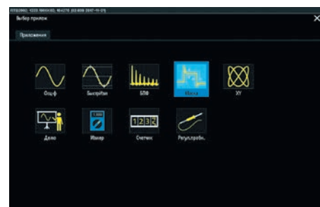
Рис. 17. Меню выбора приложений осциллографа RTB2002
