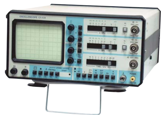
Рис. 1. Внешний вид осциллографа С1-131
