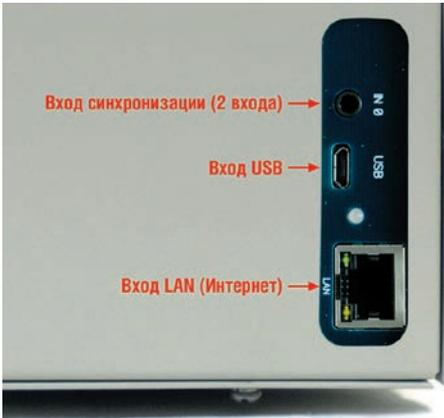
Рис. 3. Внешний вид задней панели APS-3320LS
