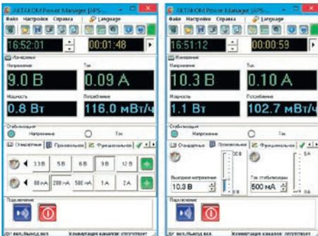
Рис. 4. Основная панель с предустановленными значениями напряжения и тока и панель ввода произвольных значений в программном обеспечении АКТАКОМ Power Manager
