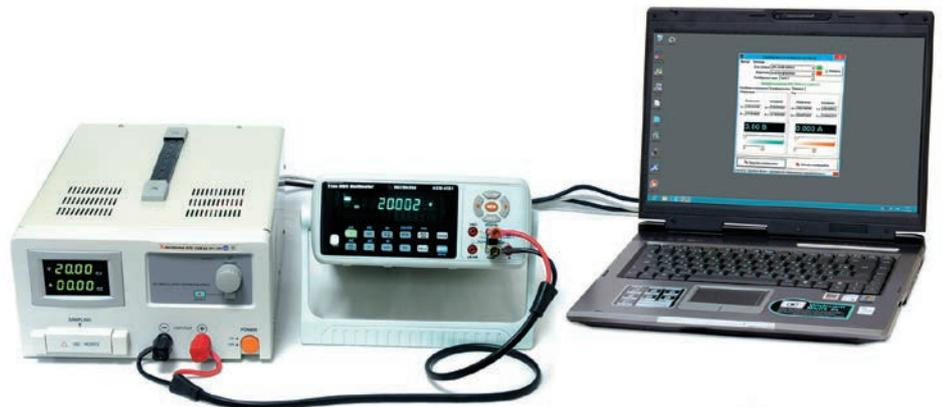
Рис. 11. Стенд калибровки источников питания АКТАКОМ серии APS-3xxxLS для работы в режиме дистанционного управления
