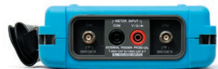
Рис. 8. Верхняя панель прибора для подключения измерительных проводов мультиметра (в центре) и пробников осциллографа
