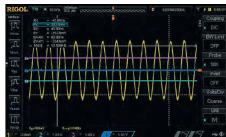
Рис. 6. Измерение максимальной рабочей частоты при четырех включенных каналах (104 МГц)
