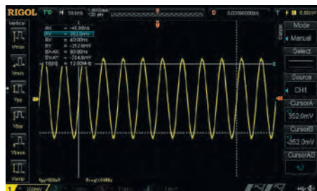
Рис. 3. Измерение максимальной рабочей частоты при одном включенном канале (100 МГц)
