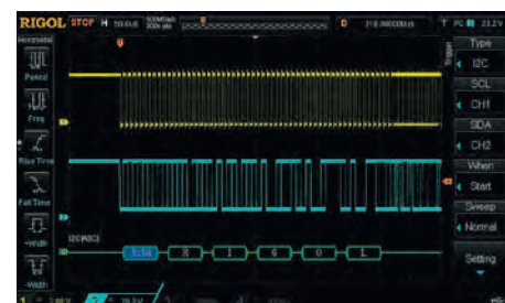
Рис. 13. Запуск по последовательным шинам (тип шины I 2 C)
