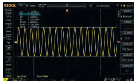
Рис. 5. Измерение максимальной рабочей частоты при одном включенном канале (139 МГц)
