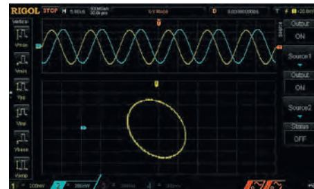
Рис. 16. Одновременное отображение сигналов с генератора (2 канала) и результирующая фигура Лиссажу на осциллографе
