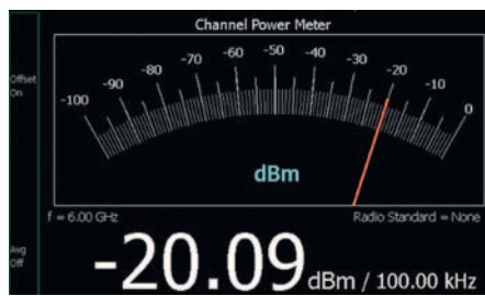
Рис. 3. Пример измерения анализатора спектра, демонстрирующий спектр немодулированного сигнала, полученный свипированием с полосой обзора 500 кГц. Для сравнения измерение выполнялось с помощью (а) анализатора спектра с маркером, (б) датчика мощности и (с) анализатора спектра FieldFox со встроенным CPM. Заметьте, что результаты всех трёх измерений отличаются менее чем на 0,1 дБ: (а) измеренная средняя мощность равна -20,08 дБм, (б) -20,00 дБм и (с) -20,09 дБм
