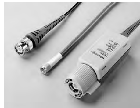
Рис.2.5. Высоковольтные пробники могут измерять постоянные напряжения до 20 кВ и импульсы до 40 кВ в полосе 75 МГц
