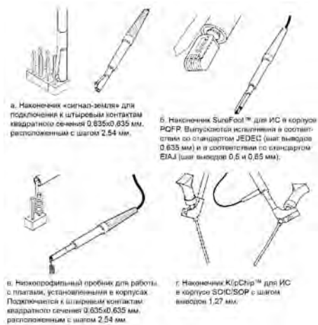
Рис. 2.16. Примеры наконечников для малогабаритных пробников. Некоторые наконечники значительно упрощают подключение к миниатюрным контактам и могут повышать точность измерения, предлагая высокоинтегрированное решение для подключения к контрольным точкам
