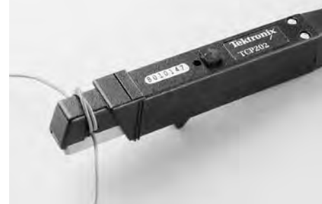
Рис. 2.8. Пример пробника переменного тока с разъемным сердечником. Для увеличения чувствительности пробника в n раз нужно намотать на сердечник n витков проводника
