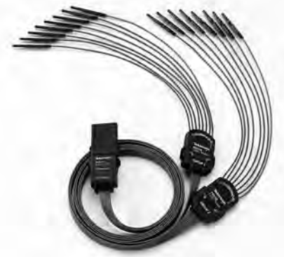
Рис. 2.10. Логический пробник для осциллографа смешанных сигналов (MSO) упрощает подачу сигналов вашего устройства на цифровые каналы
