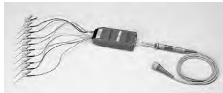
Рис. 2.9. Пробник с функцией декодирования. Такие пробники позволяют использовать осциллографы для анализа специальных информационных сигналов при отладке цифровых устройств
