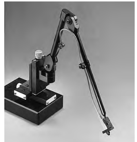
Рис. 2.11. Пример зондовой станции для работы с миниатюрными устройствами, такими как гибридные и твердотельные ИС
