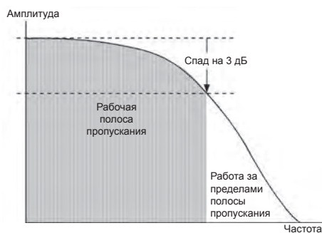
Рис. 1.5. Пробники и осциллографы рассчитаны на выполнение измерений с определенными характеристиками в рабочей полосе пропускания. На частотах, лежащих за пределами полосы по уровню 3 дБ, амплитуда сигнала начинает падать, и результаты измерения могут быть непредсказуемыми
