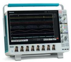
Рис. 10. Осциллограф смешанных сигналов Tektronix MS058
