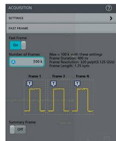
Рис. 11. Окно установки режима Fast Frame в осциллографах Tektronix серии MS05
