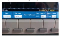
Рис. 7. Меню установки параметров записи ADS-6122
