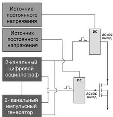
Рис. 13. Пример функциональной схемы тестирования МДП-транзистора
