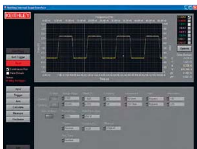
Рис. 12. Окно платы цифрового осциллографа 4200-SCP2 компании Keithley Instruments
