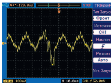
Рис. 15. Воспроизведенная форма произвольного сигнала, который по форме аналогичен захваченному ранее осциллографом АКТАКОМ АСК-6209
