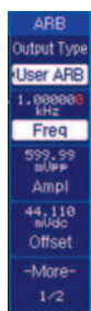
Рис. 10. Выбор режима генератора для работы с пользовательской формой сигнала на экране осциллографа АКТАКОМ АСК-6209
