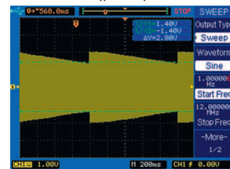
Рис. 18. Полоса пропускания пробника HP-9060 с делителем 1:1 ограничена величиной 12 МГц
