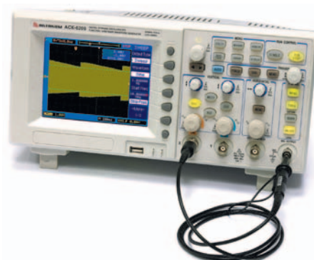
Рис. 16. Подключение пробника HP-9060 для снятия АЧХ
