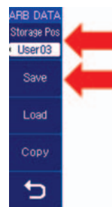
Рис. 12. Сохранение формы сигнала с осциллографа во внутреннюю память генератора осциллографа АКТАКОМ АСК-6209
