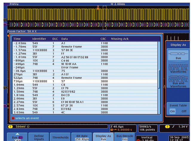
Рис. 5. Таблица событий с декодированными данными шины CAN
