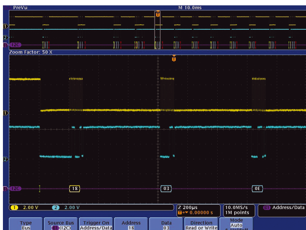
Рис. 4. Запуск и декодирование на примере последовательной шины I2C
