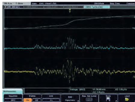
Рис. 5. Измерение АЭП импульса типа «вспышка»
