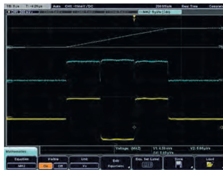
Рис. 4. Результат измерений АЭП встроенного импульса с использованием расчетных осциллограмм
